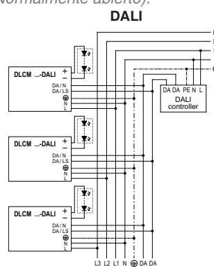
~ **Función corredor:** sistema para controlar el nivel de luz con un sensor de movimiento convencional conectado en los bornes DALI. Cuando el sensor detecta presencia, el nivel de luz aumenta al 100%, en caso contrario, el equipo mantiene un 10% de nivel de luz.
